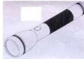
El presente diseño está caracterizado por un foco que tiene una parte de iluminación y una agarradera substancialmente cilíndrica. La sección media de la agarradera está decorada con segrinado rugoso que comprende un patrón de engranaje. La región segrinada rugosa como un anillo rodea uno de los extremos de la agarradera. La memoria descriptiva, reivindicaciones, resumen y diseños quedan depositados,
