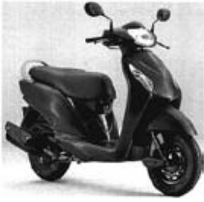
El diseño de una motocicleta que tiene una cubierta frontal en forma de "X", entre las luces direccionales a ambos lados, y una luz en forma de escaleno hexagonal. La memoria descriptiva, reivindicaciones, resumen y diseños quedan depositados, la Clasificación Internacional de Diseños Industriales es:12/11 ; cuyo(s) inventor (es) es (son) Tanawut Kaewthong, Sirintip Bunprasert, Nitin S. Nagdavane. La
