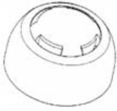
La tapa comprende un cuerpo de la tapa apta para ser engarzada a un contenedor, por ejemplo atornillándola y en el extremo superior del cuerpo de la tapa hay un domo transparente. El domo contiene internamente una bola pequeña. La memoria descriptiva, reivindicaciones, resumen y diseños quedan depositados, la Clasificación Internacional
