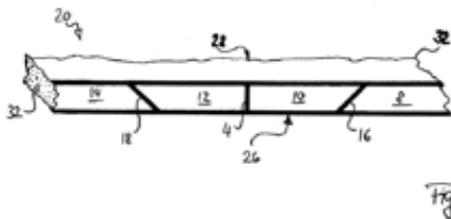
La invención se refiere a un método para producir un panel sándwich hecho de al menos una capa de recubrimiento (26, 28) a laminar y al menos un bloque de material de una
