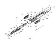
Un bisturí universal de seguridad retráctil que comprende un mango que tiene un sección proximal y una sección distal con un orificio de extensión longitudinal que define una carcasa; un elemento porta-cuchillas que tienen una sección media, un extremo proximal y un extremo distal
