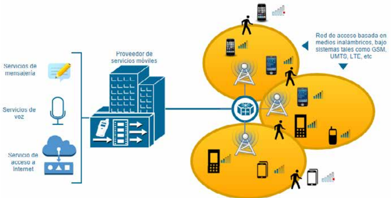
Figura 1 Diagrama general de las redes móviles.
