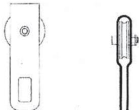
El diseño industrial tal como se muestra y describe consiste en una polea (pulley) para canopy, tirolesa o tirolina. Se define como polea, una o más rolas colocadas en un bloque o cobertor que se utilizan para conectar un cable a un conector o accesorio de montañismo, y que reduce la fricción mientras el conector o
