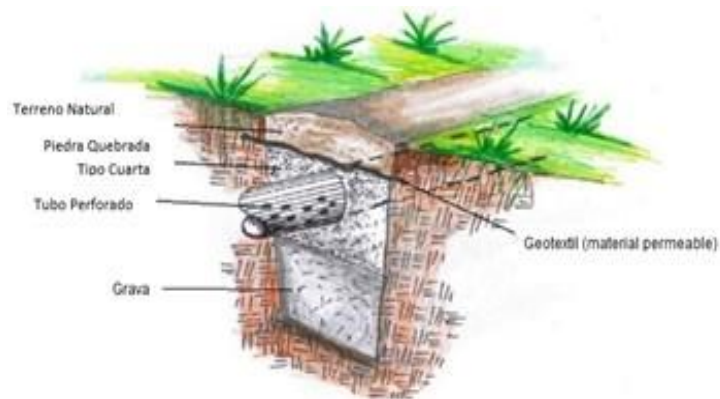
Figura C. Detalle de zanja para drenajes
